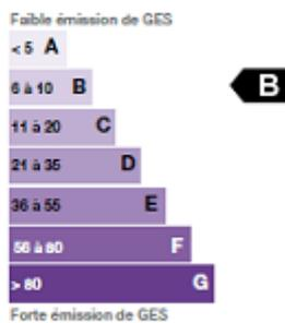
Etiquette climat : kWh équivalent CO<sub>2</sub>, par m<sup>2</sup>, par an
