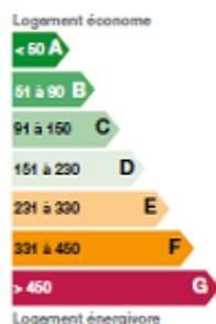
Etiquette énergie : kWh équivalent pétrole, par m<sup>2</sup>, par an
